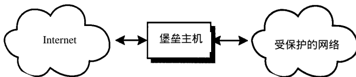
图16-2 一个Dual-homed主机防火墙
