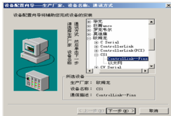
图9 组态王软件设备定义
