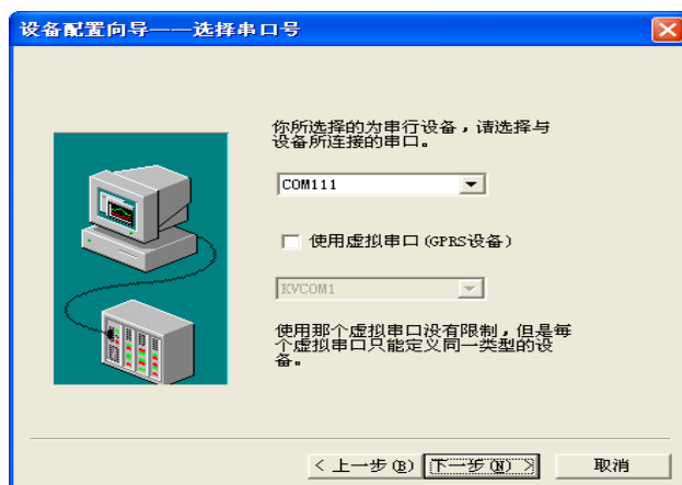
图 D2 以太网设备串口的分配
