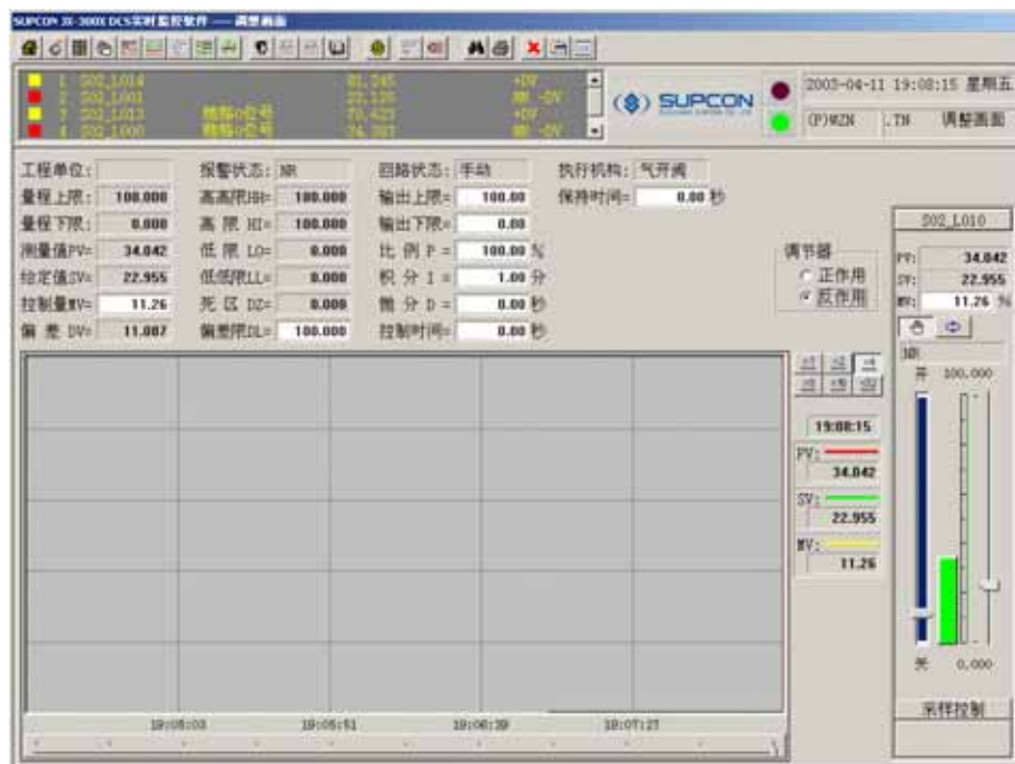
AdvanTrol 中采样控制回路调整画面
