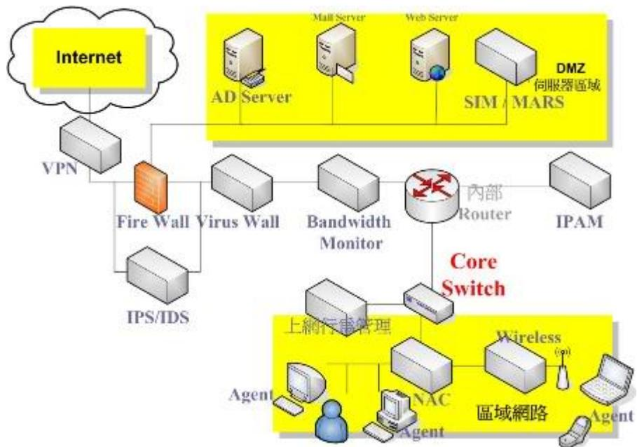
Switch 一般也要到 Core 等级才可加入 IPS 模块，就如同 Router 一样，主要就是加上入侵侦测的功能，在客户环境 Switch 效能 ok，也不打算多买设备，可以加入模块方式来保护网络。
