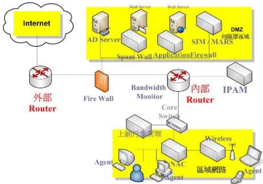
Router 通常是 Cisco 的 Router 才能加上资安的解决方案，Cisco 新一代 Router 都叫 ISR(Integrated Service Router)，可以整合 IPS 或 Voice 模块，在外部的 Router 通常我们希望它扮演好 Router 的角色即可，而内部买不动一台 IPS 设备时，会建议客户从现有的 Router 上加上 IPS 模块。
