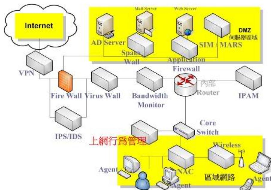
上网行为管理设备在配置上有两种方式，Inline Mode(配置在 Gateway)或是 MirrorMode(配置在 CoreSwitch)，上图是从 CoreSwitch 直接 Mirror 流量的方式，两种方式各有优缺，从 Gateway 在进行阻挡时较快且直接！但设备挂掉时要考虑 hardware bypass 的功力！而 Mirror 好处是完全不改变原有架构导入很容易，但是在进行阻挡时，需同时送封包给远方目的 server 与来源 client 联机，网络频宽资源较吃！到底哪个好，还是依环境而定。
