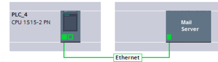
图 5-13 S7-1500 CPU 与邮件服务器间的 OUC 安全通信
