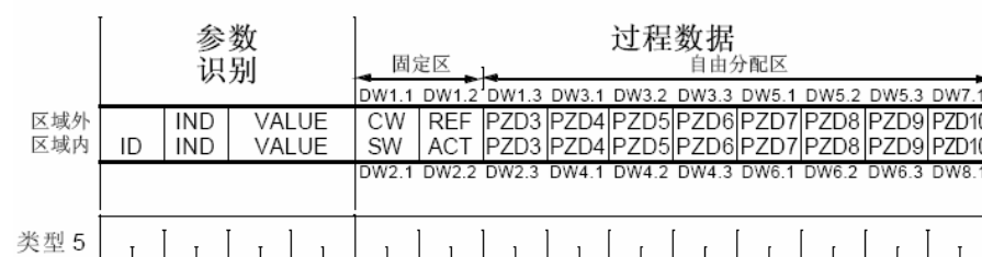
图 3-4 使用 RPBA-01 适配器模块在传动系统和上位机系统之间进行双向的 10 个过程数据传送的 PROFIBUS 通讯
