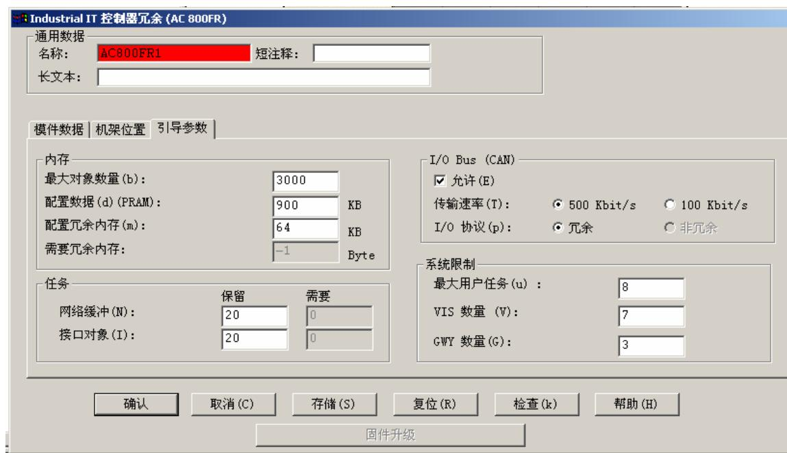
参数配置完成后，选择 **编辑---插入**，添加控制器的模块；
