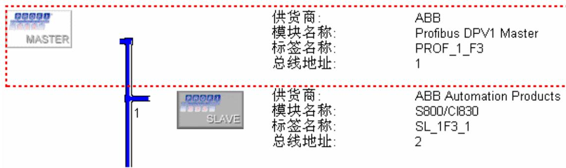
双击下面的接点: Node1, 进入 Profibus Slave 参数配置界面
