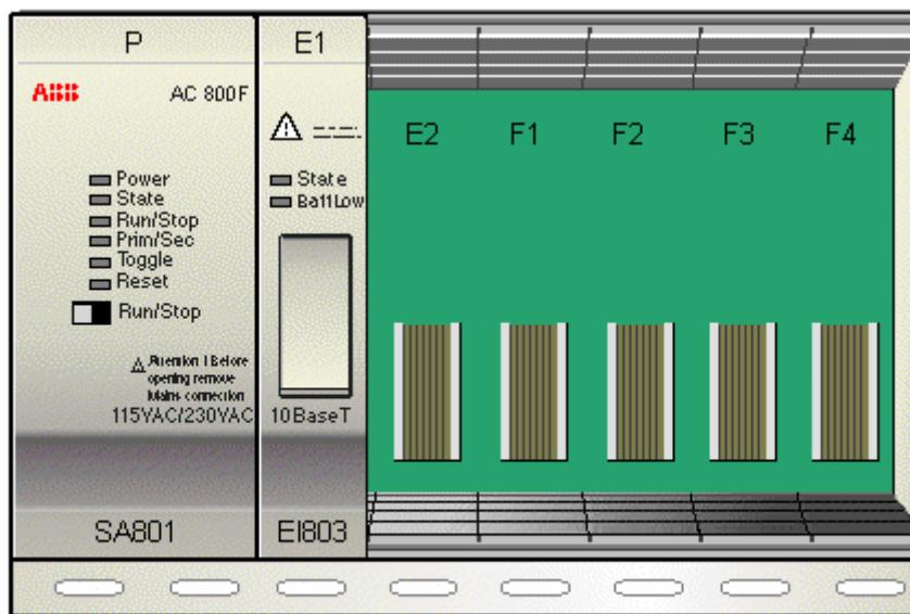
冗余控制器需要插入 2 个以太网模块 EI803F，即 E1, E2 槽均需配置 EI803F。
