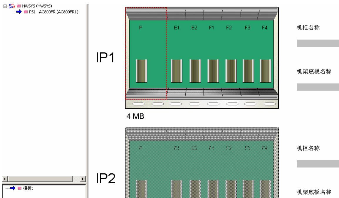
双击 PS1 AC800FR (AC800FR1) 在 机架位置 菜单条下, 填写相应的机架名称, 机架底板名称等;
