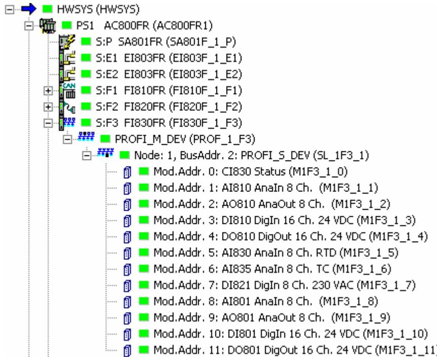
在硬件结构的右下方可以看到模块安装位置，模块名称，模块类型等；
