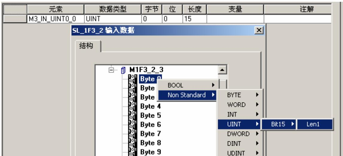
类似 Byte0，拆分 Byte2，Byte4，Byte6，Byte8 如下，并填写变量及注解：
