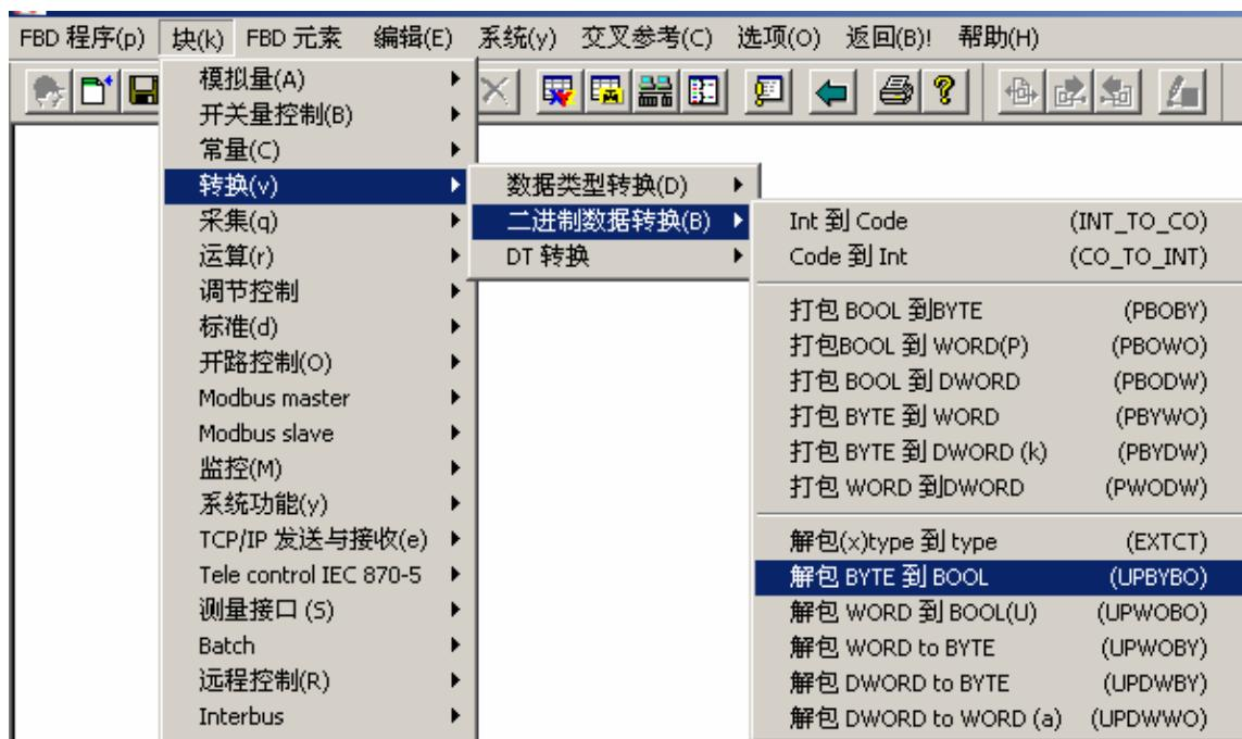
添加功能块将 Bool 型数据转换为 Byte 型, 将 Bool 型数据转换为 Word 型：
