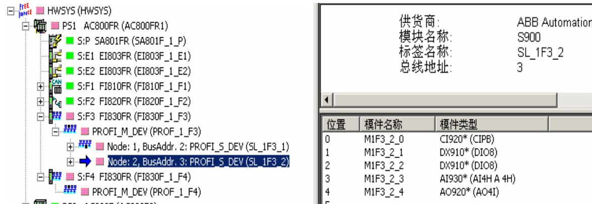
在 F4 插槽同样可以插入仪表作为从站，此处选择 ABB-04C2.GSD 以及 ABB-04C4.GSD，同样先选择添加 Profibus Master
