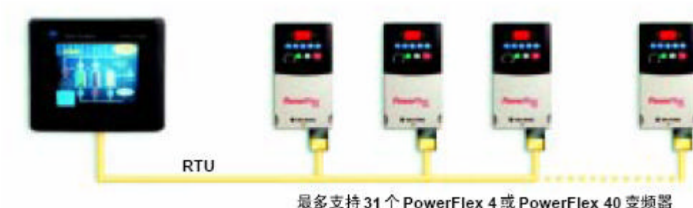
图 3-122 RTU 主站设备控制 PowerFlex4
