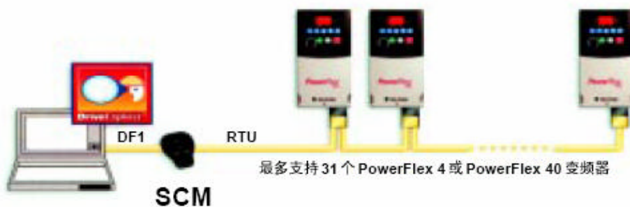
图 3-120 PC 机监控 PowerFlex4
