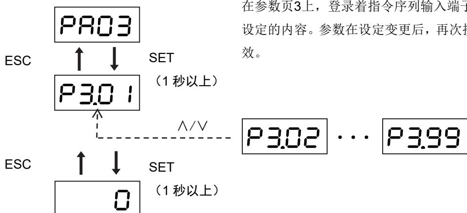
在参数页3上，登录着指令序列输入端子等有关系统设定的内容。参数在设定变更后，再次接通电源时有效。
