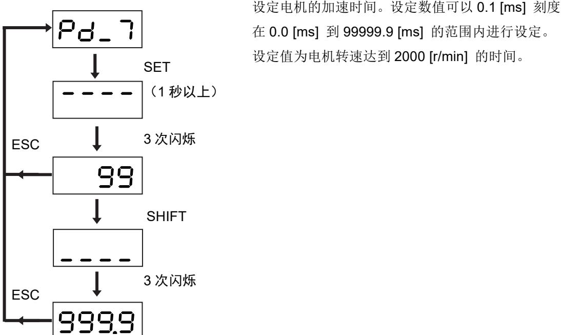
设定电机的加速时间。设定数值可以 0.1 [ms] 刻度
