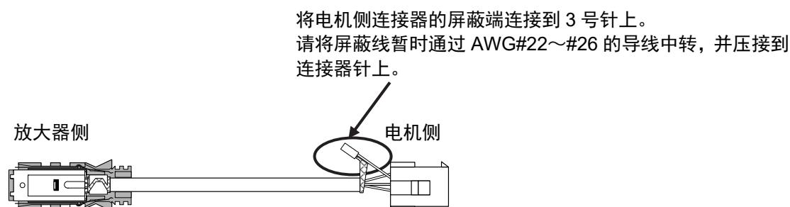
GYB 型号连接器连接规格时
